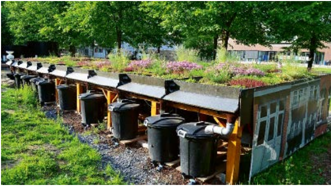
Abb. 1: Halbtechnische Versuchsanlage für extensive Gründachaufbauten
